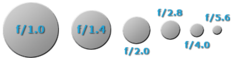
شکل ۴. ارتباط بین اندازه دهانه دیافراگم و ضریب f
