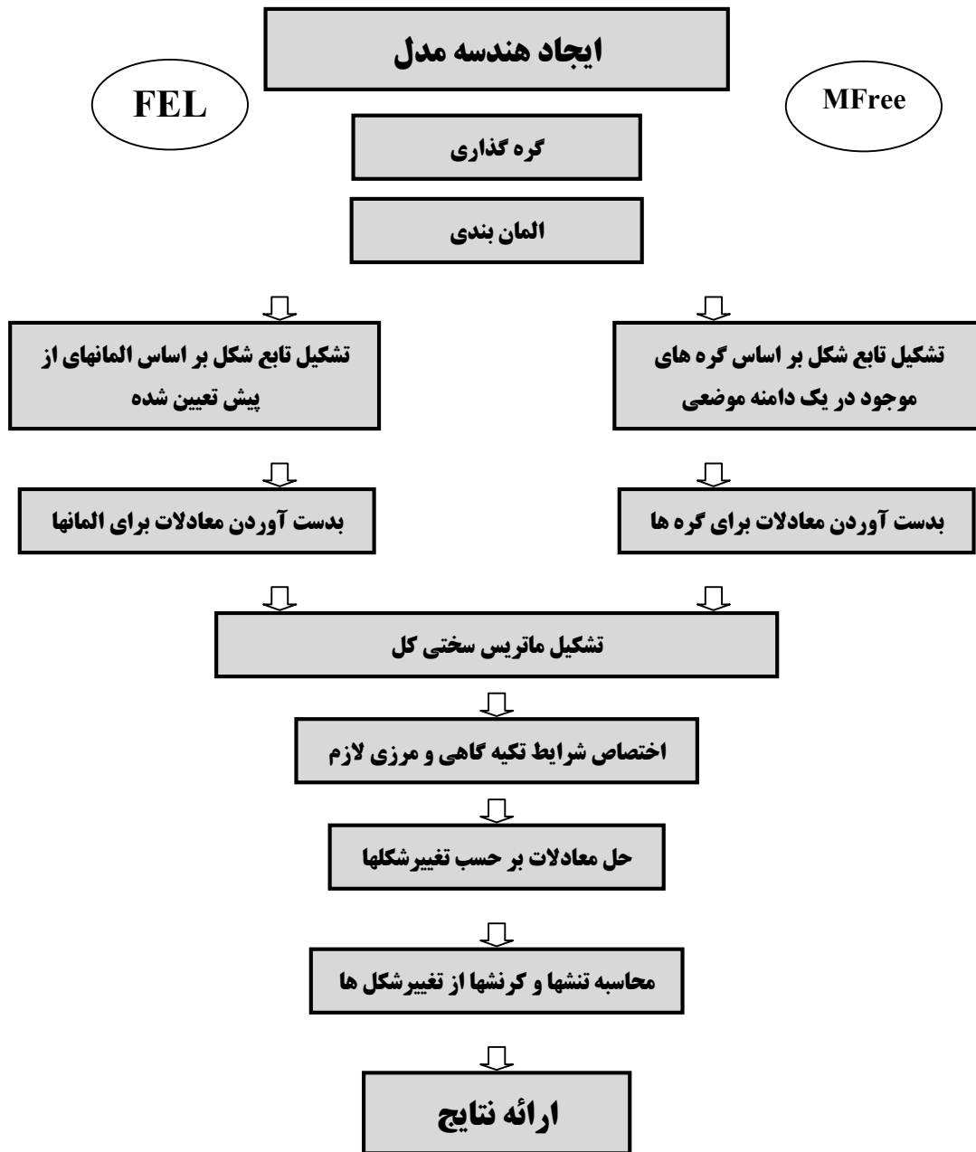
شکل ۲-۲- فلوچارت مراحل حل در روش اجزاء محدود و روشهای بدون جزء
