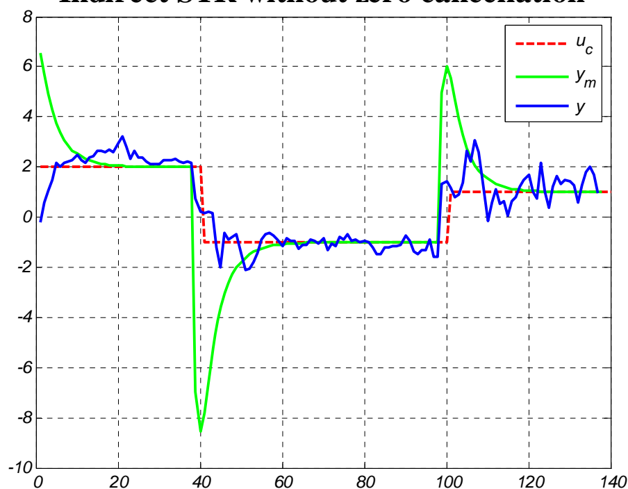
شکل (۱۱): پاسخ سیستم حلقه بسته همراه با خروجی مطلوب و ورودی مرجع در حضور نویز سفید و روش شناسایی RLS.
