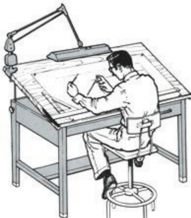
شکل ۱-۲: میز نقشه‌کشی و نحوه قرار گیری کاغذ و سایر ابزار نقشه‌کشی بر روی آن (شاه و رانا، ۲۰۰۹)
