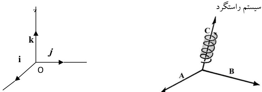
شکل ۳-۵- برآیند دو بردار با استفاده از قانون دست راست شکل ۳-۴- بردارهای یکه در سه بعد
